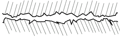
Figura 2.2: A nivel microscópico, incluso las superficies lisas son ásperas.
