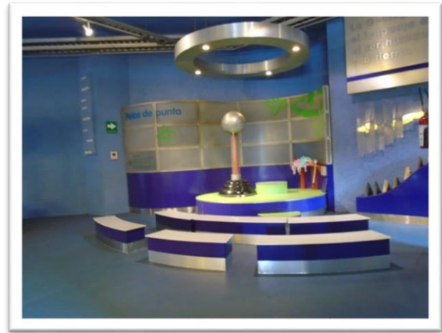
Fotografía 6. Papalote. Pelos de Punta. Se muestra temáticas como la estática, crea diferencias de potencial o tensiones, produciendo por ello grandes voltajes trasportar elevadas cantidades de carga eléctrica, generadas por contacto, hacia la parte superior donde se encuentra una esfera metálica hueca que actúa como terminal.
