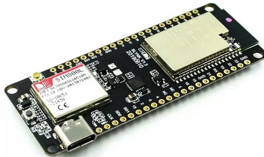
Figura 1.4: Vista del módulo TTGO T-Call V1.3 con ESP32 y SIM800L.
