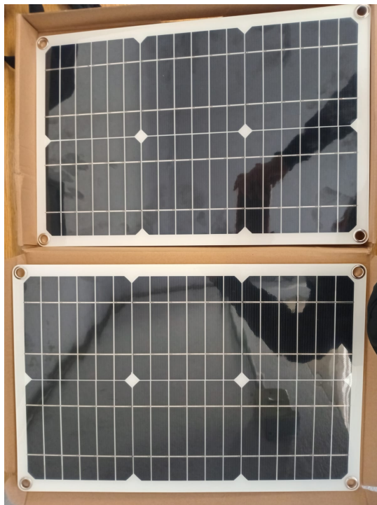
Figura 3.8: Celda solar de 6V/5W utilizada para alimentar el sistema en modo autónomo.
