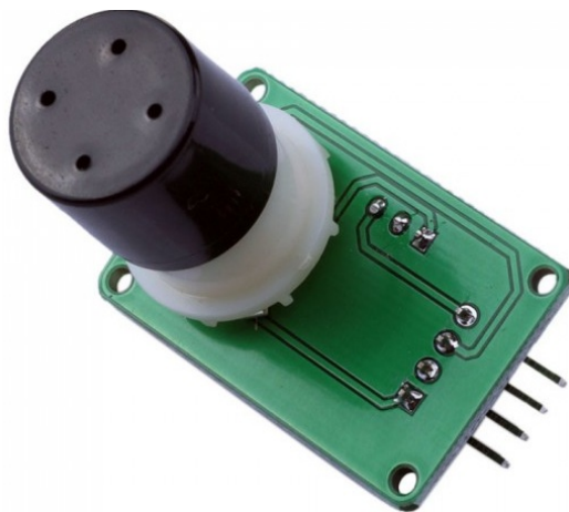
Figura 2.3: MQ-131(Sensor de ozono)
