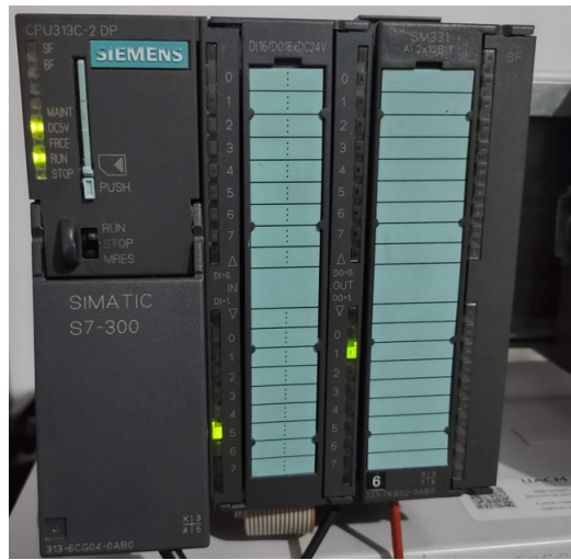
Figura 2.18: PLC de la marca Siemens modelo CPU 313C-2 DP + módulo analógico SM331.
