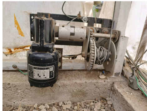
(b) Motor adaptado a un malacate.
