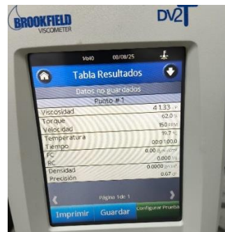
C: Velocidad de rotación de 150 rpm o 200 rpm con un torque aceptable del 50%
