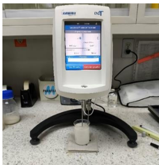
A: Viscosímetro con aguja RV1, RV 3 y RV 5
