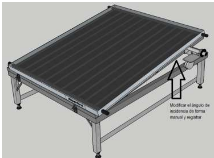
Figura 25. Ajuste de ángulo de incidencia en el colector solar
