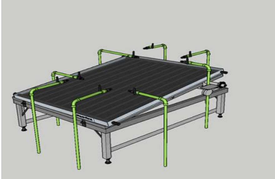
Figura 31. Penetración de lluvia
