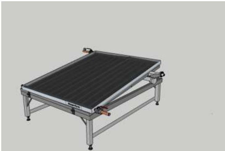
Figura 16. Colector solar en el banco de pruebas
