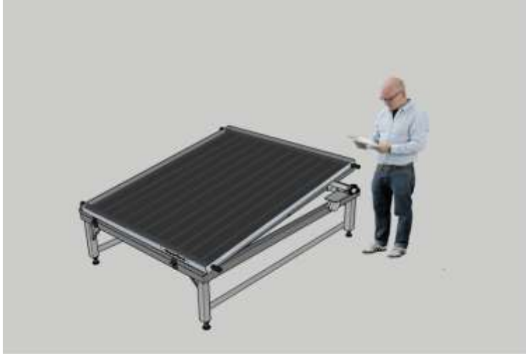
Figura 11. Inspección a la Recepción del Colector
