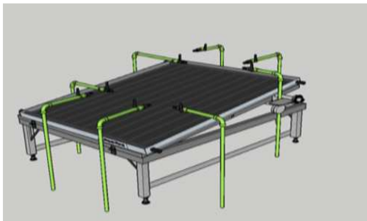
Figura 70. Aspersores para pruebas de penetración de lluvia
