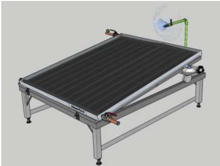
Figura 29. Rociado de agua a temperatura ambiente
