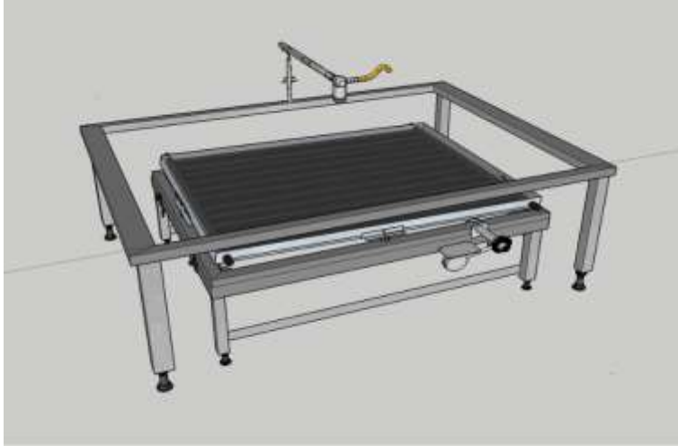
Figura 76. Banco de pruebas de impacto (colector plano)
