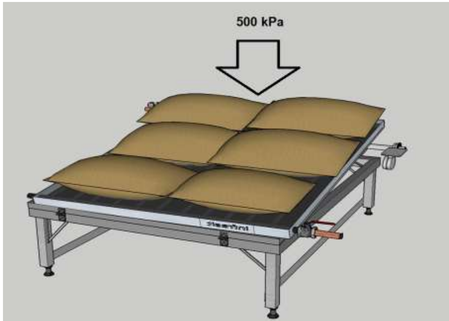
Figura 32. Carga uniformemente distribuida a colector placa plana
