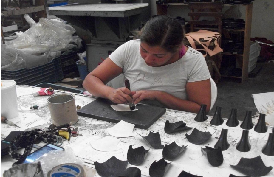
Figura 9: Embarrado de pegamento para los tacones. Foto tomada por Esthefania Reyes Gutiérrez
